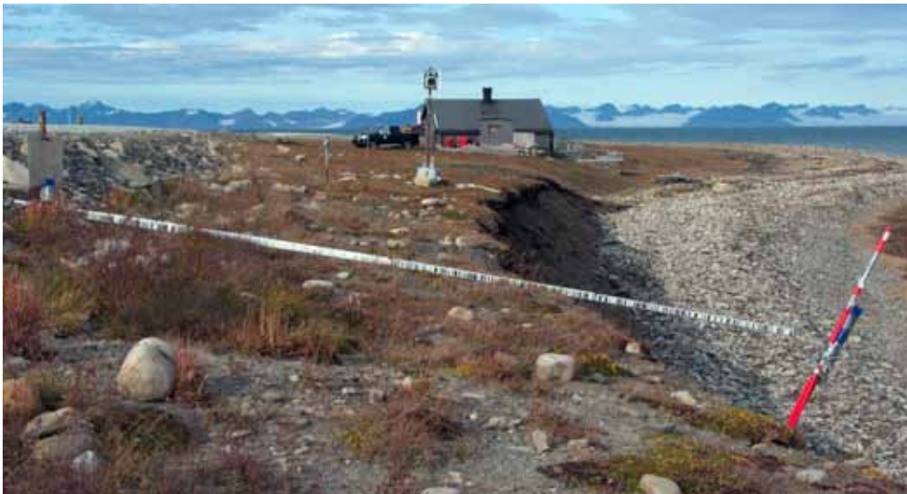
Et vitenskapelig instrument som måler erosjon har i flere år stått i veikanten mot Vestpynten. Kanten mot sjøen nærmer seg faretruende instrumentet.
